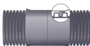
Spajanje cevi sa naglavkom
